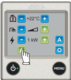
1. Starten Sie den Gasbetrieb durch Druck auf die Flüssiggasflamme. Das Symbol für Flüssiggas wird aktiviert und erscheint nun in grün.
