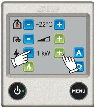
1. Aufrufen und Umschalten zwischen der verschiedenen Heizstufen (Off, 1 kW, 2 kW und 3 kW) mit + oder -. Der eingestellte Wert wird auf dem Bildschirm angezeigt. Bei Aktivierung wird das Plus-Symbol grün angezeigt. Wenn der \*Belastungswächter installiert und eingestellt ist, benutzt die Heizung nicht mehr Elektrizität als sie braucht, auch wenn 3kW gewählt wurde.
