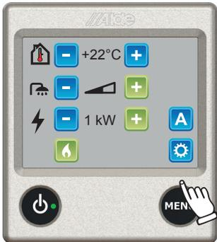
1. Bedieneinheit im Einstellungsmenü Drücken Sie auf das Werkzeugsymbol, um zum Werkzeugmenü zu gehen.
