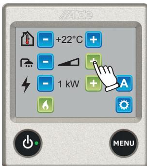
2. **Normalbetrieb.** Wenn Frischwasser aufgefüllt ist und Warmwasser gewünscht wird, drücken Sie auf + (das Symbol ist halb gefüllt).
