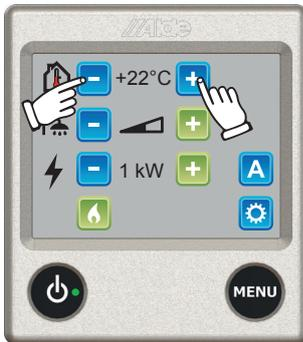
1. Die angezeigte Temperatur ist die gegenwärtig eingestellte.
