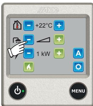
1. **Kein Warmwasser.** Falls es kein Bedarf an Warmwasser gibt, drücken Sie auf - (Das Symbol wird leer).
