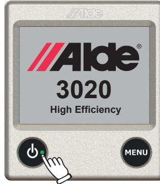
1. Zum Einschalten der Heizung Ein-Aus-Schalter drücken, dann erscheint die Startanzeige. Die Heizung wird mit den zuletzt verwendeten Einstellungen eingeschaltet.
