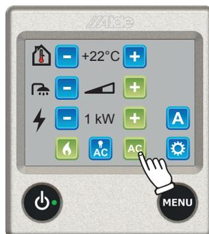
Kühlung benötigt werden. Zum Abschalten der Klimaanlagen-Funktion den Klimaanlagen-Schalter drücken; dieser wird dann blau. In dieser Position lässt sich die Fernbedienung der Klimaanlage verwenden.
