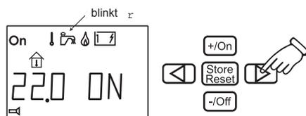
2 Schalten Sie Warmwasser ab, indem Sie auf den -/Off-Knopf drücken. "OFF" wird neben der Temperatur auf dem Display angezeigt.
