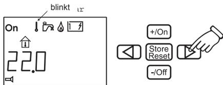
2 Erhöhen Sie die Temperatur, indem Sie den +/On-Knopf drücken. Senken Sie die Temperatur, indem Sie den -/Off-Knopf drücken. In der Abbildung haben wir die Temperatur auf 25,0°C eingestellt.
