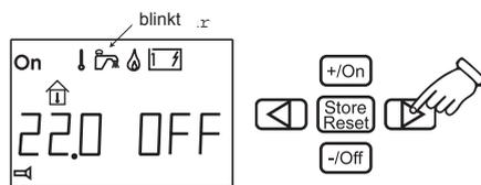
2 Schalten Sie Warmwasser ein, indem Sie auf den +/ON-Knopf drücken. "ON" wird neben der Temperatur auf dem Display angezeigt.
