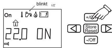
3 Das Symbol für Warmwasser wird angezeigt, wenn die Bedieneinheit wieder in Ruhestellung geht.
