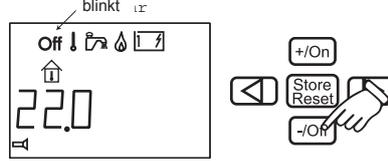
3 Die Einstellungen sind fertig. „Off“ (Hauptschalter) wird im Display angezeigt, wenn die Bedieneinheit in Ruhestellung geht.
