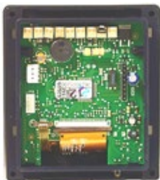
Alternativ 1 Baksida av panel 3010, utan svarta, röda eller gula kontakter.
