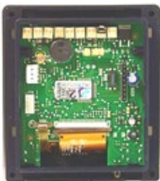
Ausführung 1: Rückseite des Bedienfeldes 3010, ohne schwarze, rote oder gelbe Anschlussklemmen.
