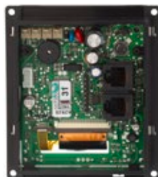
Ausführung 2: Rückseite des Bedienfeldes 3020 HE / 3020, mit schwarz-schwarzen Anschlussklemmen.
