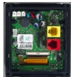
Ausführung 3: Rückseite des Bedienfeldes 3020 HE, mit gelben / roten Anschlussklemmen.
