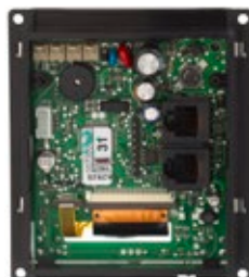
Version 2 arrière du panneau 3020 HE et 3020, avec contacts noirs/noirs.
