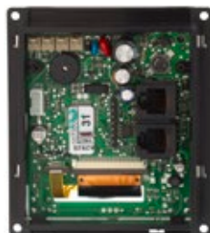
Alternativ 2 Baksida av panel 3020 HE och 3020, med svart / svarta kontakter.
