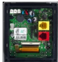
Version 3 arrière du panneau 3020 HE avec contacts jaunes/rouges.
