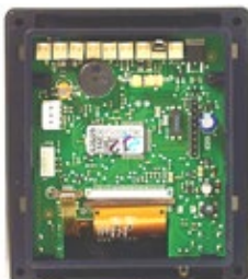
Version 1 arrière du panneau 3010, sans contacts noirs, rouges ou jaunes.
