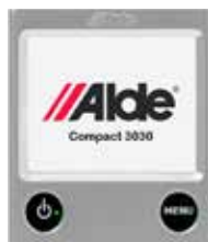
2. System läuft an, LED leuchtet
