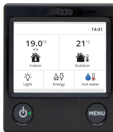
Fig. 12. Écran de démarrage de zone unique, avec climatisation (en option) installée.
